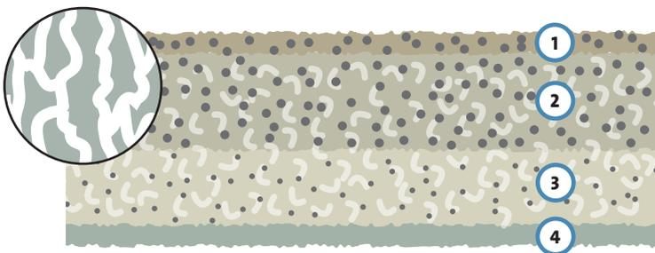
Der Aufbau und die Struktur von Tiefenfiltern sind damit mit einem äußerst engmaschigen dreidimensionalen Sieb mit zahllosen Verästelungen vergleichbar. Im immer enger werdenden Porenlabyrinth werden Partikel und Mikroorganismen mechanisch zurückgehalten. Die Partikel werden dabei in den Poren des Filtermediums abgelagert.
